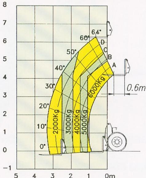
Tragkräfte: bei 600 mm Lastschwerpunktstand (FEM 4001r)
